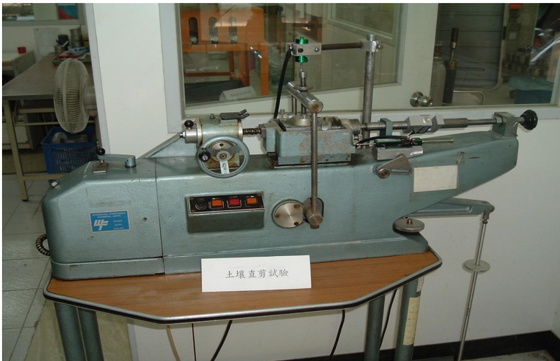
土壤直接剪力試驗
