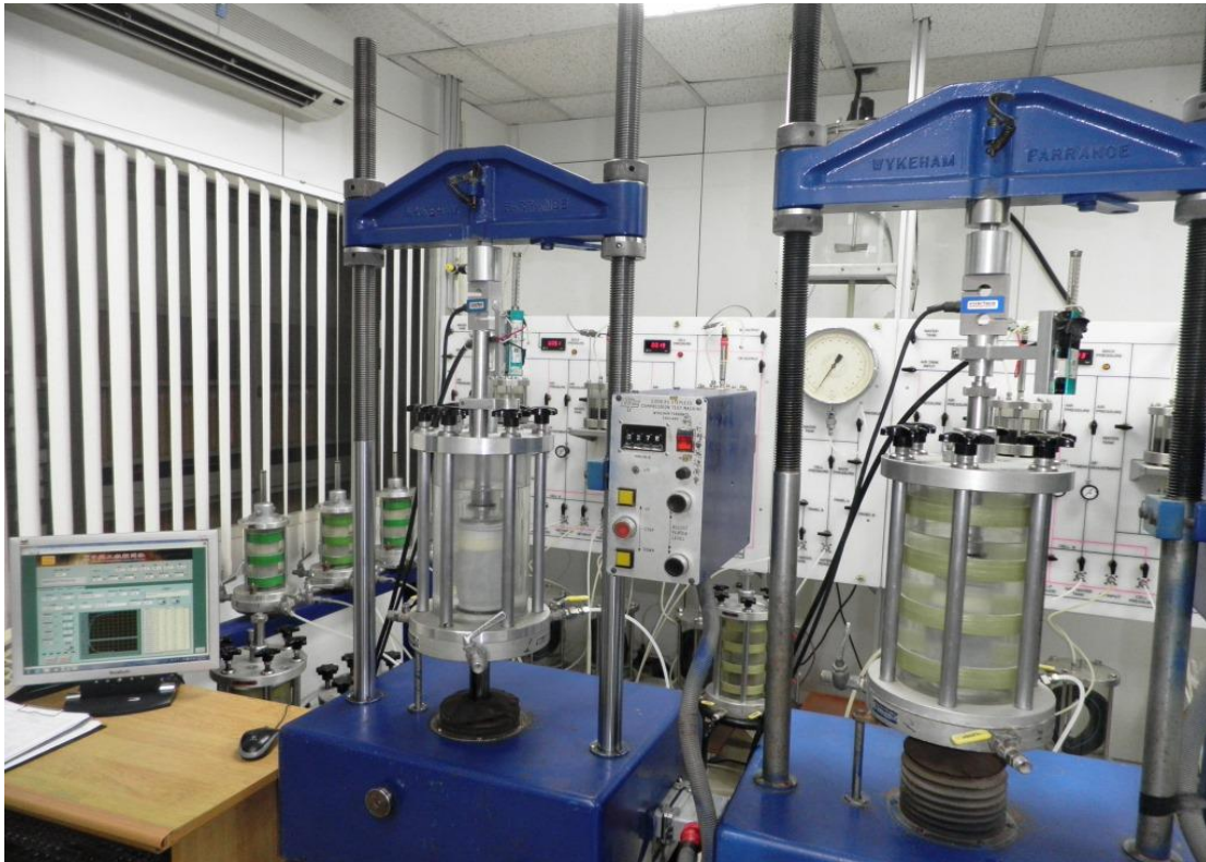
土壤三軸壓縮強度試驗(UUU、SUU、CIU、CID)
