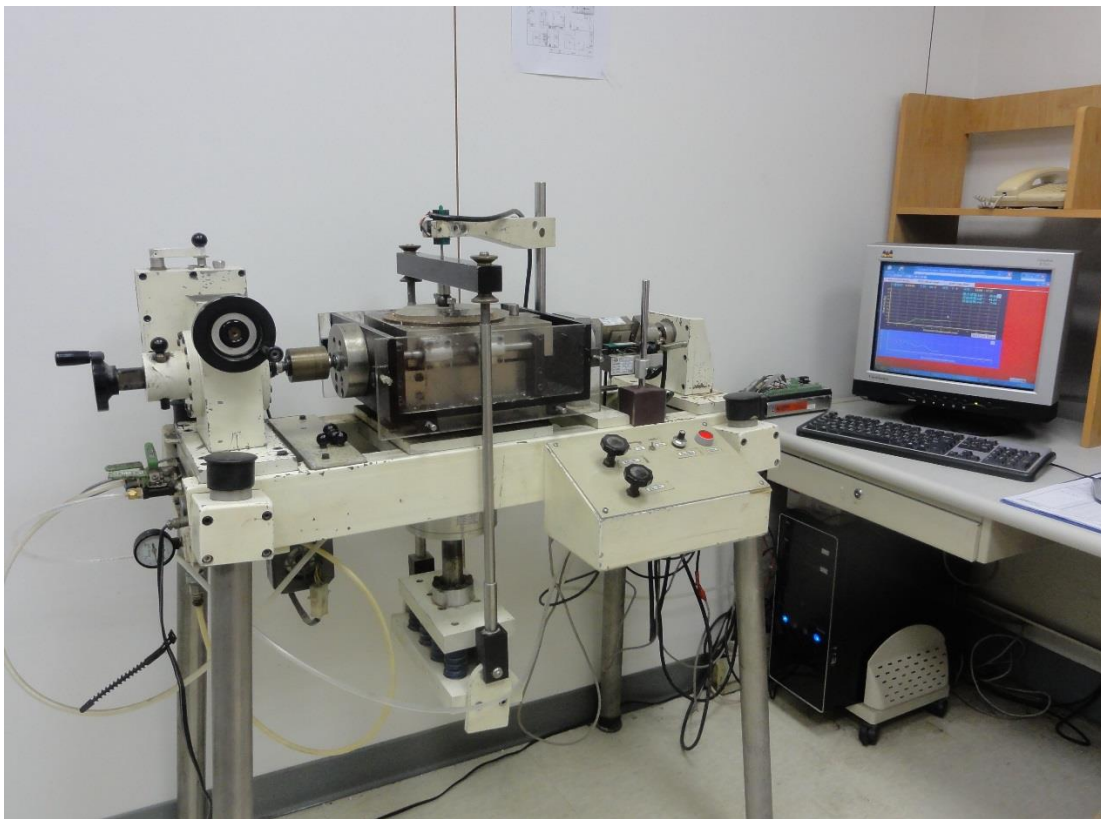
岩石直接剪力試驗
