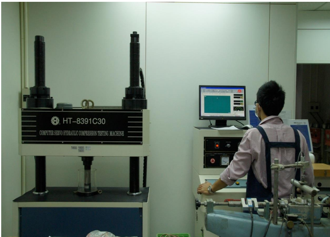
岩石單軸抗壓強度試驗
