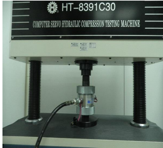
HOEK CELL 及高壓管線
