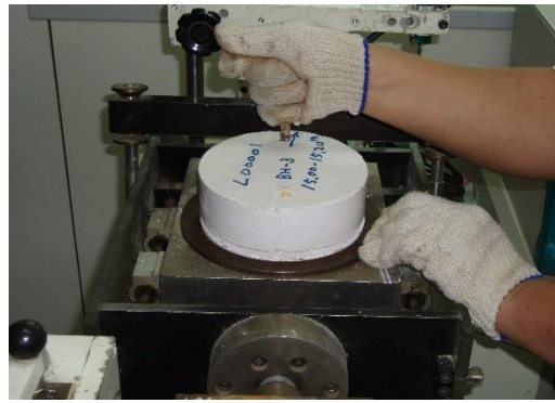
灌模後試體放入試驗機
