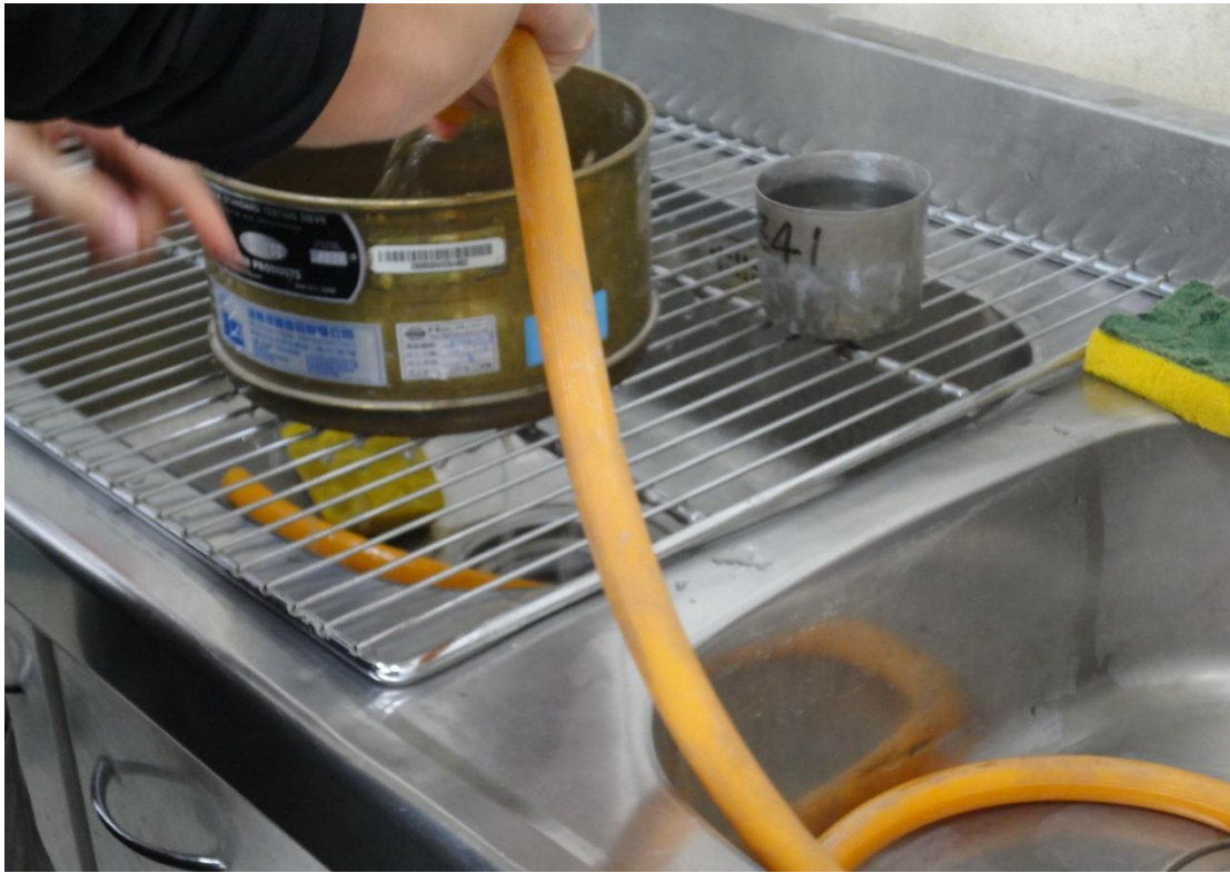
土壤內小於 75\ \mu\text{m} (# 200) 篩材料含量試驗
